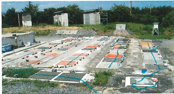
表面色は異なる。比較対象の舗装材は、普通インターロッキングブロック、透水性インターロッキングブロック、普通平板、透水平板および密粒度アスファルトとした。インターロッキングブロックと平板は、JIS A 5371付属書の推奨仕様に適合するものを使用した。普通インターロッキングブロックは、配合は同一で表面色の異なる12種類を使用した。
