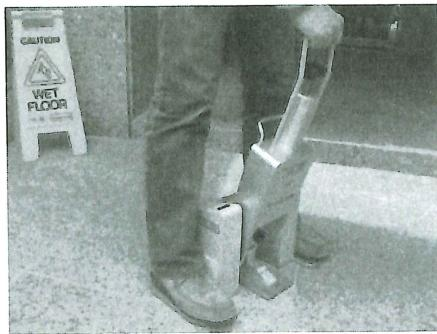
写真-5 靴・床すべり静止摩擦測定器(TL501)
