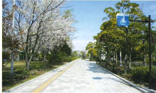
写真2 近年の IL ブロック舗装の適用事例(歩行者・自転車専用道路)
