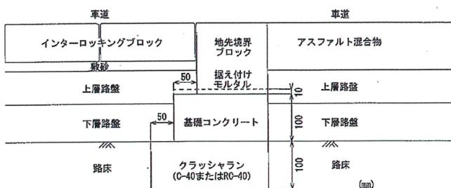
図1 地先境界ブロックによる端部拘束の構造例
